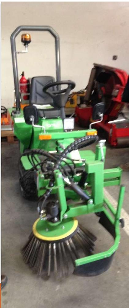
Du désherbage mécanique pour trottoirs et voirie en bon état adaptable sur appareil tractant
